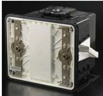
図1 ウェハをパーティクルから保護する FOUNDRY OVER UNDER PROTECT (FOUP)
