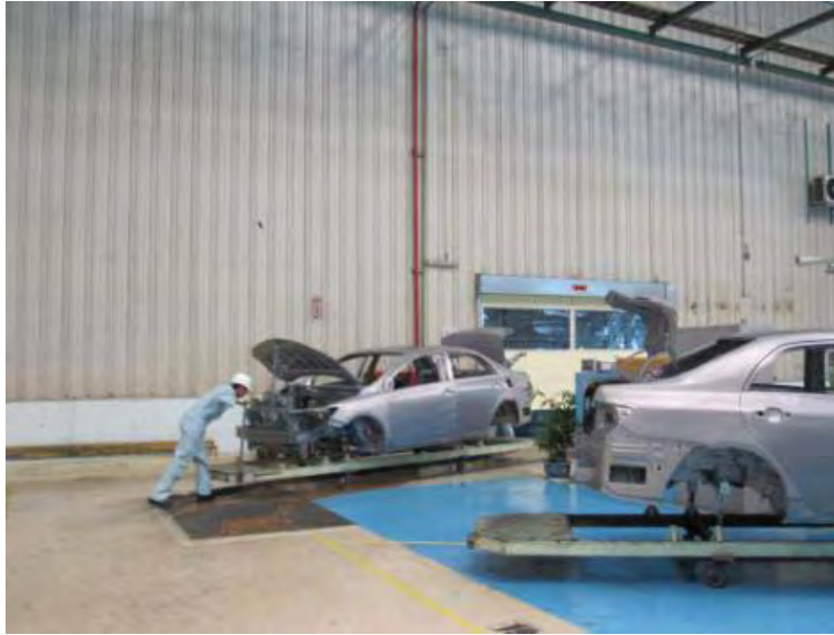
写真4 手押し台車で運ばれるホワイトボディ
