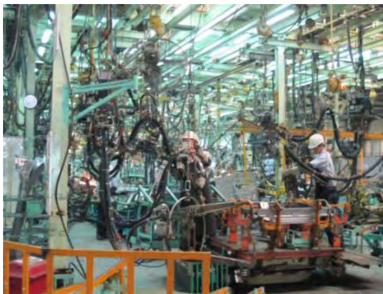
写真 3 人手による溶接工程
