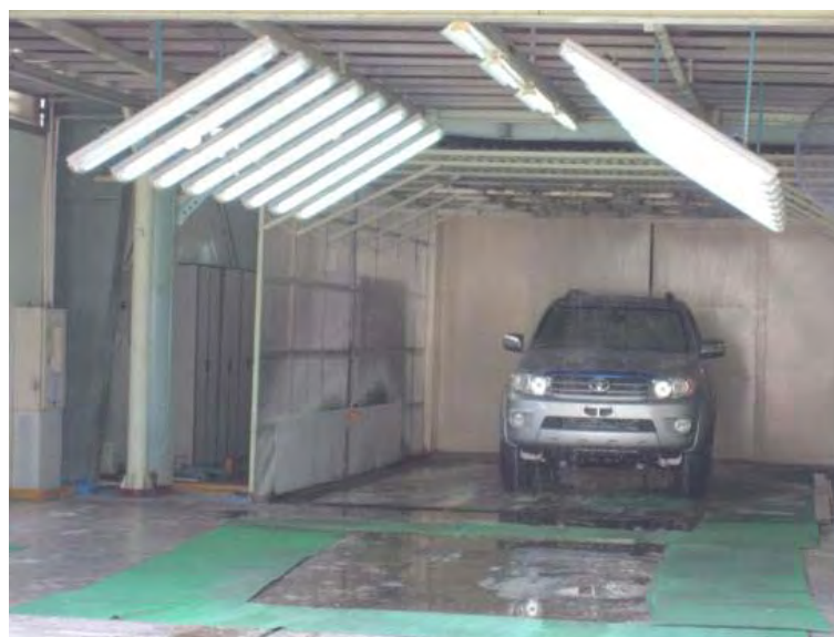
写真6 シャワーテストと外観検査
