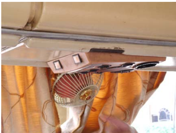
大型バスのエアコン吹き出し口
